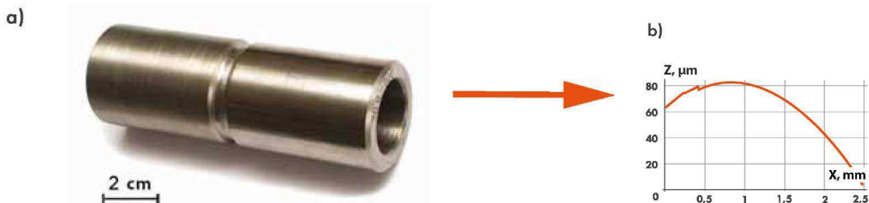
Rys. 12. Tuleja (a) oraz odpowiadający jej profil powierzchni cylindrycznej (b).
